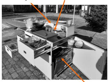
eine Seite bestückbar mit ein/zwei "Kängabox"-Isolierbehältern (Euronorm-Größe), zur Aufnahme von GN/gastronorm-Behältnissen, und GN-Kühlplatte
