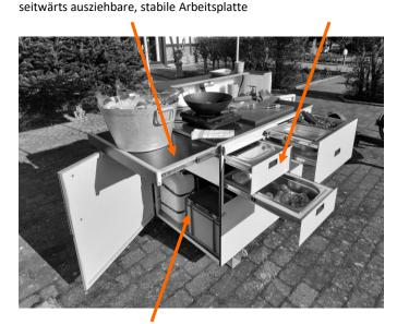
zweite Seite für integrierte Technik: 20-Liter Frischwassertank, sowie Abwassertank, Wasserpumpe, Warmwasserbereiter; Elektroverteilung, Steckdose unter Barblatt
